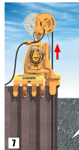
7 ジェットリールの巻取り力にてホースを引抜く。
